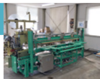
導入した全自動反転式平刺機 ロボオートHM-6B
