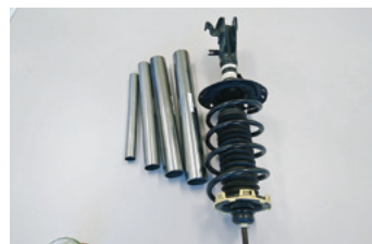
ショックアブソーバーと各チューブ、機器部品
