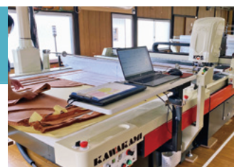
導入したコンピュータ制御自動裁断機
